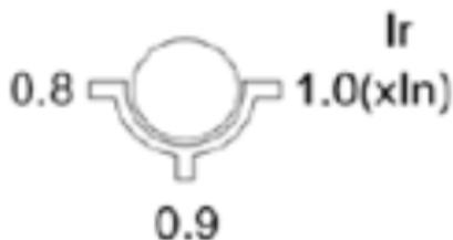
La función de protección contra sobrecarga proporciona una curva de límite de tiempo inversa basada en bimetálico. Si se excede el límite, la deformación del bimetálico puede hacer que se dispare el mecanismo de operación del interruptor. Rango térmico ajustable: 0.8, 0.9 y 1.0In.
