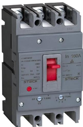
Los interruptores caja moldeada ofrecen una solución segura y robusta para los proyectos eléctricos de gran envergadura. El modelo regulable cuenta con ajuste térmico del 80% de la corriente nominal y regulación magnética, para protección de corrientes de sobre carga.
