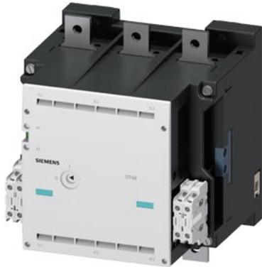
contactor en vacío AC-3e/AC-3 630 A, 335 kW / 400 V, Ue 690 V, de 3 polos, Uc: 200-240 V AC50/60 Hz, accionamiento: convencional bloques de contactos auxiliares 4 NA + 4 NC circuito ppal.: barra circuito de control y auxiliar: borne de tornillo
