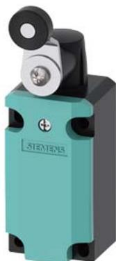
interruptor de posición caja metálica 40 mm según DIN EN 50041 Conexión del aparato 1x (M20 x 1,5) 1NA/1NC contactos de acción brusca Actuador de fracción de vuelta derecha/izquierda ajustable, palanca metálica 27 mm de longitud y rodillo de plástico de 19 mm
