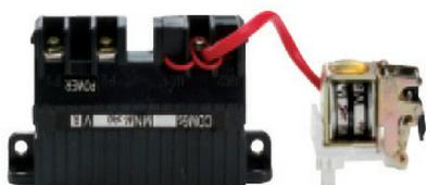
Es utilizada para disparar el interruptor cuando hay falta o caída de tensión nominal de la bobina. El interruptor solamente podrá ser rearmado si hay tensión en el circuito de bobina. (Bobina energizada).
